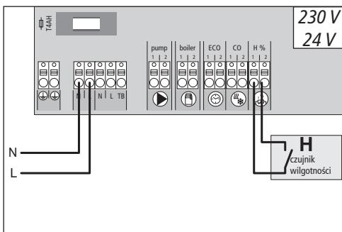
Dostarczane przez użytkownika na miejscu montażu czujniki wilgotności służą do ochrony przed obroszeniem powstającym w trybie chłodzenia.
