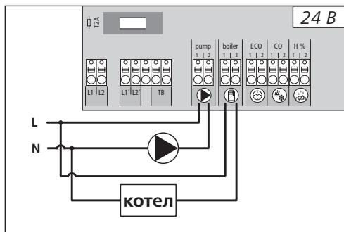
Подключение через разъем Boiler (котел) позволяет управлять генератором тепла. Кроме того возможно управление насосом.
