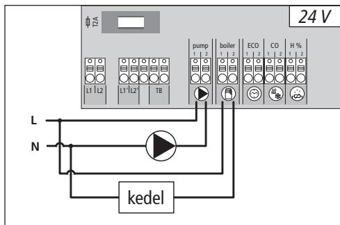
Tilslutningen Boiler (kedel) giver mulighed for at styre en varmegenerator. Desuden kan en pumpe styres direkte.
