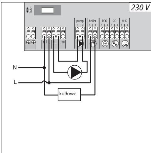
Złącze Boiler (kocioł) umożliwia sterowanie generatorem ciepła. Ponadto możliwe jest bezpośrednie zasilanie i sterowanie pompy.
