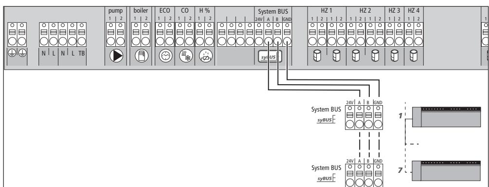
Yleisten järjestelmäparametrien synkronoimista varten voidaan kytkeä keskenään jopa seitsemän perusasemaa järjestelmäväylän (syBUS) kautta. Johtojen kytkemisen jälkeen perusasemat täytyy parittaa, katso luku 4.2. Jos johtimen halkaisija on <6 mm, on johto varustettava vetokevennyksellä.
