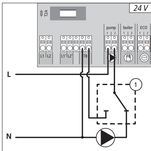
Tiloissa valmiina olevan lämpötilan turvarajoittimen liittämiseen (1). Rajoitin sammuttaa pumpun ja kytkee TB-tulon, kun lattialämmitysessä havaitaan liian korkeita lämpötiloja. Kun TB-tulo on kytketty, sulkee perusyksikkö kaikki käyttölaitteet.
