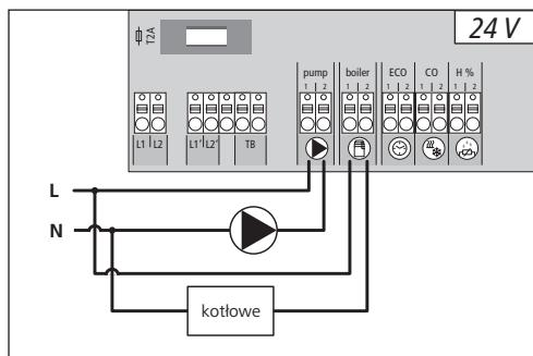
Złącze Boiler (kocioł) umożliwia sterowanie generatorem ciepła. Ponadto możliwe jest sterowanie pompą.
