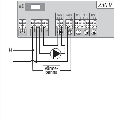
Anslutning till boiler (värmepanna) möjliggör styrning av en värmekälla. Därutöver kan en pump försörjas och styras direkt.
