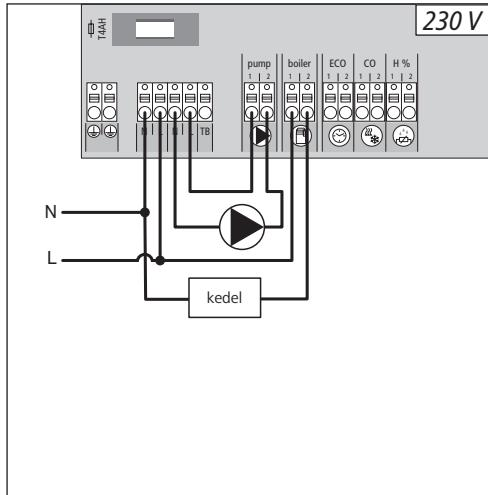
Tilslutningen Boiler (kedel) giver mulighed for at styre en varmegenerator. Desuden kan en pumpe forsynes og styres direkte.
