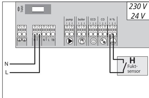
Fuktsensor som tillhandahålls på plats används som skydd mot kondens i läget kyllning.
