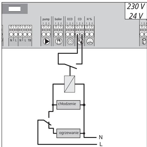
Przy wykorzystaniu zewnętrznego sygnału Change Over (CO) cała instalacja przełącza się zgodnie z sygnałem pomiędzy trybem grzania i chłodzenia.
