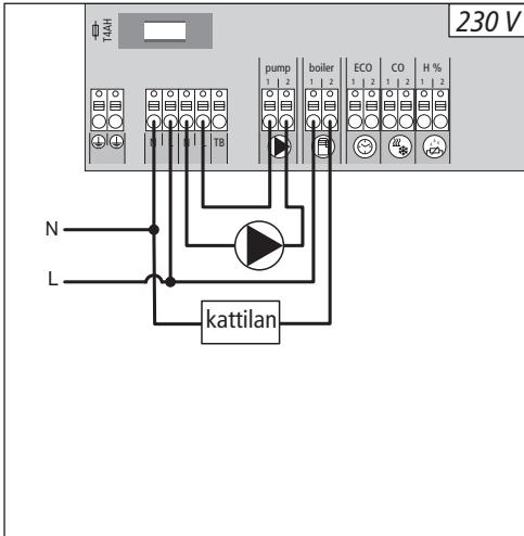
Boilerin (kattilan) liitännä mahdollistaa yhden lämmöntuottajan hallinnan. Lisäksi voidaan hallita ja syöttää suoraan yhtä pumppua.
