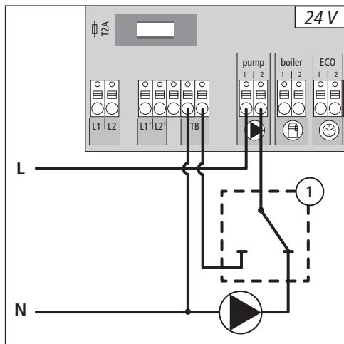
Tilslutning af en sikkerhedstemperaturbegrænsner (1). Den kobler pumpen fra og skifter til indgangen TB, hvis der registreres for høje fremløbstemperaturer i gulvvarmen. Hvis TB-indgangen tilkobles, styrer basisstationen automatisk alle drev.
