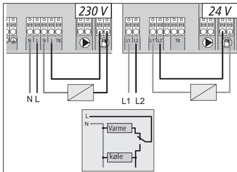
Hvis der ikke står et eksternt Change Over-signal til rådighed, kan basisstationens interne pilot-funktion bruges til omstilling af hele anlægget mellem driftstilstandene opvarmning og afkøling. Hertil anvendes et relæ, som basisstationen bruger til omskiftningen.
