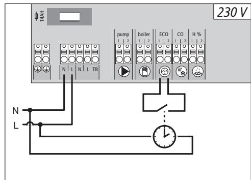
Basstationen är utrustad med en ECO-ingång för anslutning av ett externt tidur, när den interna klockan i rumskontrollens radiodisplay inte ska användas. Vid aktivering av ingången med hjälp av tiduret ställs uppvärmningszonerna in på nattdrift.
