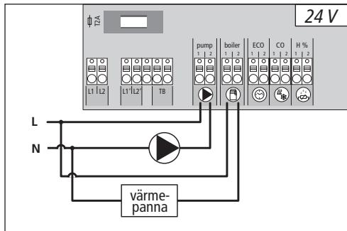
Anslutning till boiler (värmepanna) möjliggör styrning av en värmekälla. Därutöver kan en pump styras direkt.
