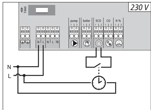
Jos ulkoista vaihtosignaalia ei ole käytettävissä, voidaan käyttää perusyksikön sisäistä pilottitoimintoa vaihtamaan kokonaislaitteisto lämmityksen ja jäähdtyksen käyttötöiden välillä. Tällöin käytetään perusyksikön vaihtorelettä.
