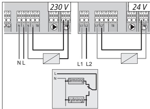
Om ingen extern Change Over-signal står till förfogande, kan den interna pilotfunktionen på basstationen användas för omkoppling av hela anläggningen mellan driftlägena värmning och kylning. Då används ett relä som basstationen utnyttjar för omkoppling.
