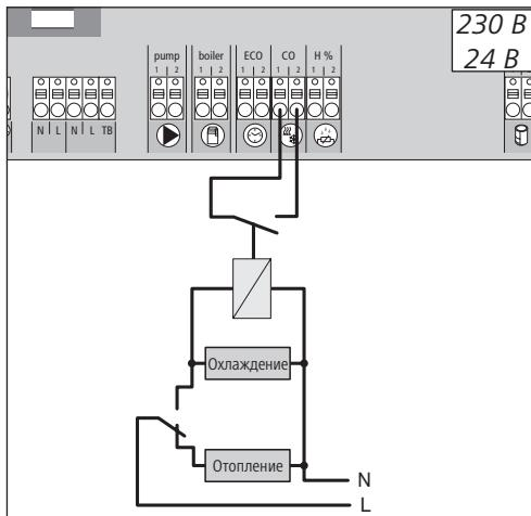
Если используется внешний переключающий сигнал Change Over (CO), то вся система переключается между режимами отопления/охлаждения согласно сигналу.
