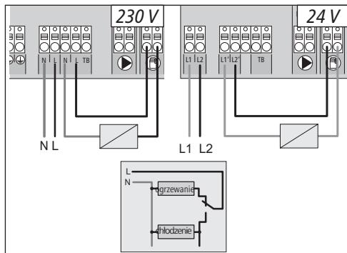
W przypadku braku dostępnego zewnętrznego sygnału Change Over (CO) można użyć wewnętrznej funkcji przełączania listwy elektrycznej służącej do przełączania całej instalacji pomiędzy trybami grzania i chłodzenia. W tym przypadku stosuje się przekaźnik wykorzystywany przez listwę elektryczną do przełączania.
