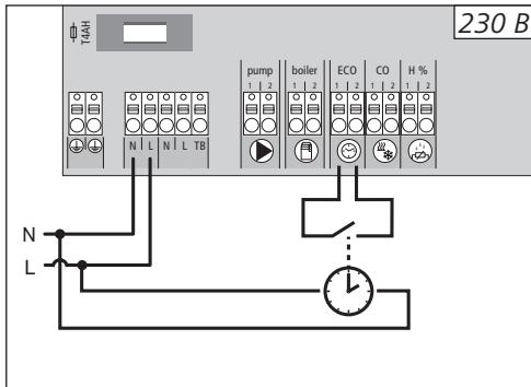
Клеммная колодка имеет вход ECO, служащий для подключения внешнего таймера в случаях, когда не будут использоваться внутренние часы на дисплее беспроводного терmostата. Если вход активируется по таймеру, зоны отопления переключаются на ночной режим.
