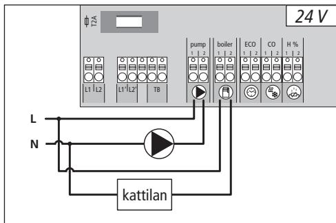
Boilerin (kattilan) liitännä mahdollistaa yhden lämmöntuottajan hallinnan. Lisäksi voidaan hallita suoraan yhtä pumppua.
