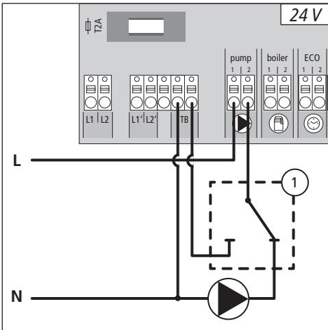
Podłączenie ogranicznika temperatury dostarczonego w miejscu montażu (1). Wyłącza on pompę i włącza wejście ograniczenia temperatury, gdy rozpoznane zostaną zbyt wysokie wartości temperatury dopływu czynnika w ogrzewaniu podłogowym. Po włączeniu ogranicznika temperatury, listwa elektryczna zamyka automatycznie wszystkie napędy.
