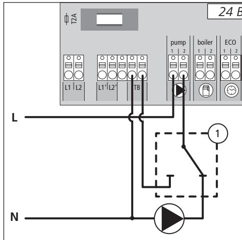
Подключение ограничителя температуры, предоставляемого заказчиком по месту монтажа (1).
