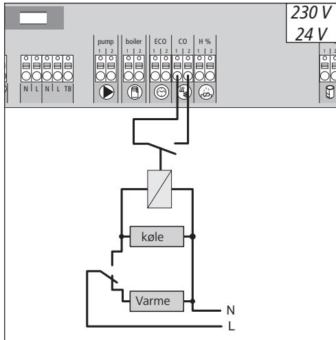
Ved brug af et eksternt Change Over-signals skifter hele anlægget mellem opvarmning og afkøling i overensstemmelse med dette signal.
