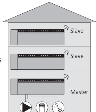
**Anvisning:** Basstationen som komponenterna är anslutna till måste konfigureras som master. Ytterligare basstationer kan endast paras med mastern.
