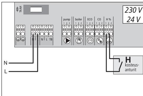
Erikseen hankittavat kosteusanturit voivat suojaa kondensivedeltä jäähdytystilan aikana.
