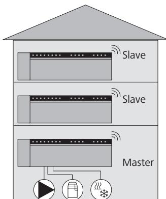
**Примечание:** базовый модуль, к которому подключены компоненты, должен быть сконфигурирован как ведущее устройство (Master). Другие базовые модули можно попарно соединить только с ведущим базовым модулем.
