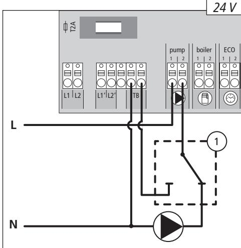
Anslut ett temperaturskydd (1), medföljer inte. Detta skydd kopplar ur pumpen och koppnar ingång TB, när för höga ledtemperaturer upptäcks i golvvärmens. Om TB-ingången kopplas startar basstationen automatiskt alla drivenheter.
