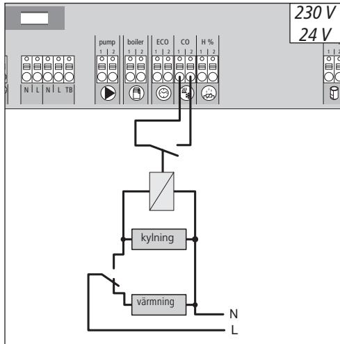
När en extern Change Over-signal används, kopplas hela anläggningen om mellan värmtning och kyllning enligt denna signal.
