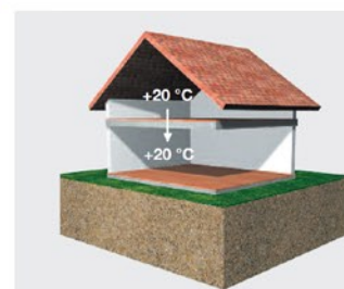
Izolace nad vytápěnými místnostmi Například LNP u patrových RD Min. tepelný odpor R = 0,75 \text{ m}^2 \text{ K/W}
