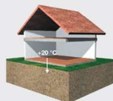
Izolace místností nad zemí Přízemí bungalovů / přízemí patrových RD Min. tepelný odpor R = 1,25 \text{ m}^2 \text{ K/W}
