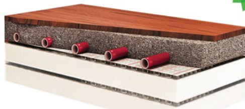
DOUBLE SUPERIZOLACE S PODLAHOVÝM TOPENÍM
